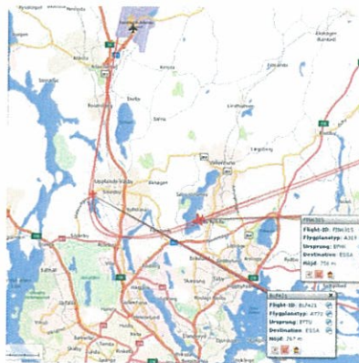
Figur 1b: Exempel på hur trafiken leds rakt över bebyggelsen i Täby kyrkby på en höjd av ca 750m för att sedan tvingas gasa för att komma in rätt till inflygningen.
